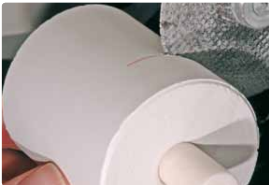
Separare il cilindro con un disco separatore e rompere nella zona predisposta alla rottura.
