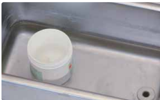
... e lasciarli per minimo 10 minuti fino a massimo 30 minuti in bagno ad ultrasuoni.
