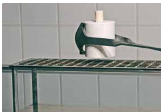
Al termine del programma di pressatura, con l'aiuto della pinza per cilindri, posizionare il cilindro caldo sulla griglia di raffreddamento e lasciare raffreddare a temperatura ambiente.
