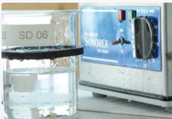
Infine detergere l'abutment ad ultrasuoni ...
