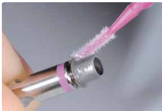
Applicare Monobond Plus sulle superfici di unione deterse e lasciare agire per 60 secondi. Successivamente, asciugare le eccedenze con getto d'aria privo d'acqua e olio.
