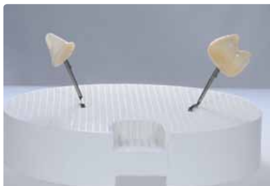
Effettuare la cottura di glasura su un portaoggetti a nido d'ape con i relativi parametri.
