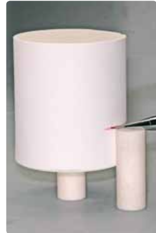
Demarcare la lunghezza del pistone in allumina
