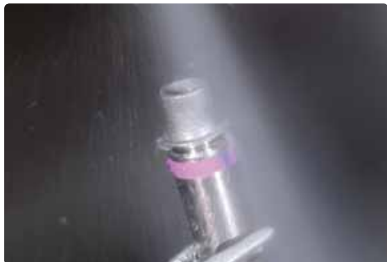
Detergere con apposito strumento e vaporizzatore. Assicurarsi che ogni residuo di cera venga accuratamente rimosso.
