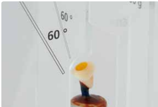
Orientamento della modellazione sulla base del cilindro, in modo tale che il canale di avvitemento sia parallelo alle pareti esterne del cilindro. In tal modo è possibile ottenere successivamente un riempimento uniforme e controllato della massa da rivestimento. Inoltre si riduce il rischio di rottura della massa da rivestimento nel canale di avvitemento durante la pressatura della ceramica.
