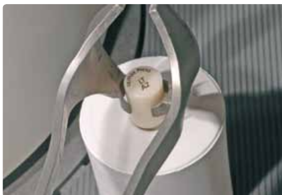
Posizionare il grezzo IPS e.max Press freddo con il colore del grezzo nel cilindro caldo verso l'alto.
