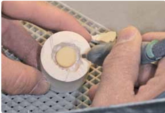
La smuffolatura grossolana avviene con sabbia per lucidatura a 4 bar di pressione, finché sono visibili gli oggetti.
