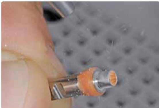
Sabbare con cura la superficie di unione con Al_2O_3 (50–100 \mu m ) a bassa pressione fino a ottenere una superficie opaca.
