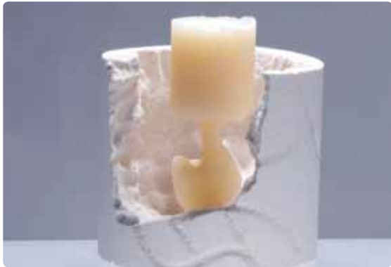
La smuffolatura fine della corona abutment avviene con perle per lucidatura a 2 bar di pressione.
