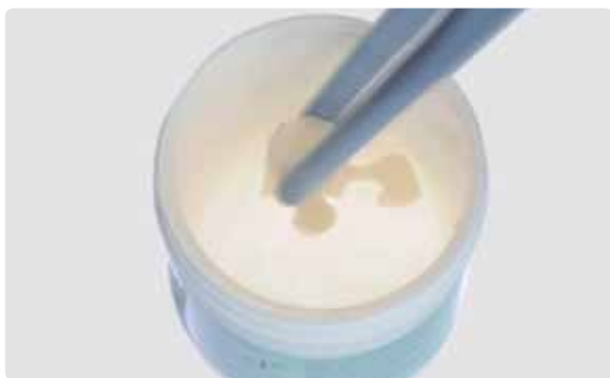
Per rimuovere lo strato di reazione, immergere gli oggetti pressati in liquido IPS e.max Press Invex...
