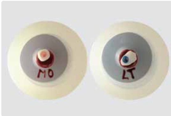
Abutment (sinistra) e corona abutment (destra) impennati correttamente. Il canale di avvitamento è verticale, parallelamente alla parete del cilindro.
