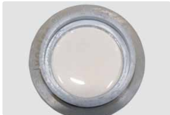
Proseguire a riempire cautamente il cilindro fino alla demarcazione ed applicare il calibro con un movimento di inclinazione.
