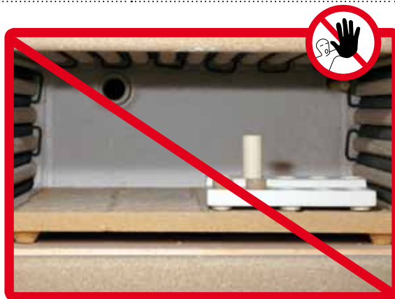
NON preriscaldare il grezzo IPS e.max Press ed il pistone in allumina.
