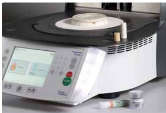
Preparare il grezzo freddo IPS e.max Press nel colore desiderato ed il pistone in allumina IPS freddo .
